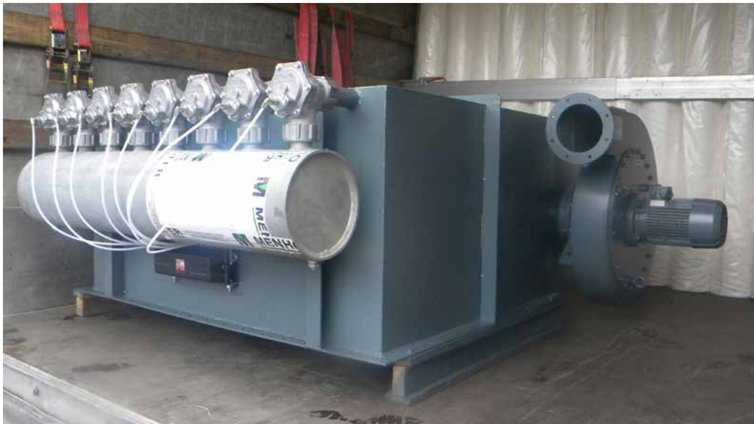
MENHOFER Oval-Schlauchfilter in Sonderbauform 720mm hoch. Ausführung als Siloaufsatzfilter.
