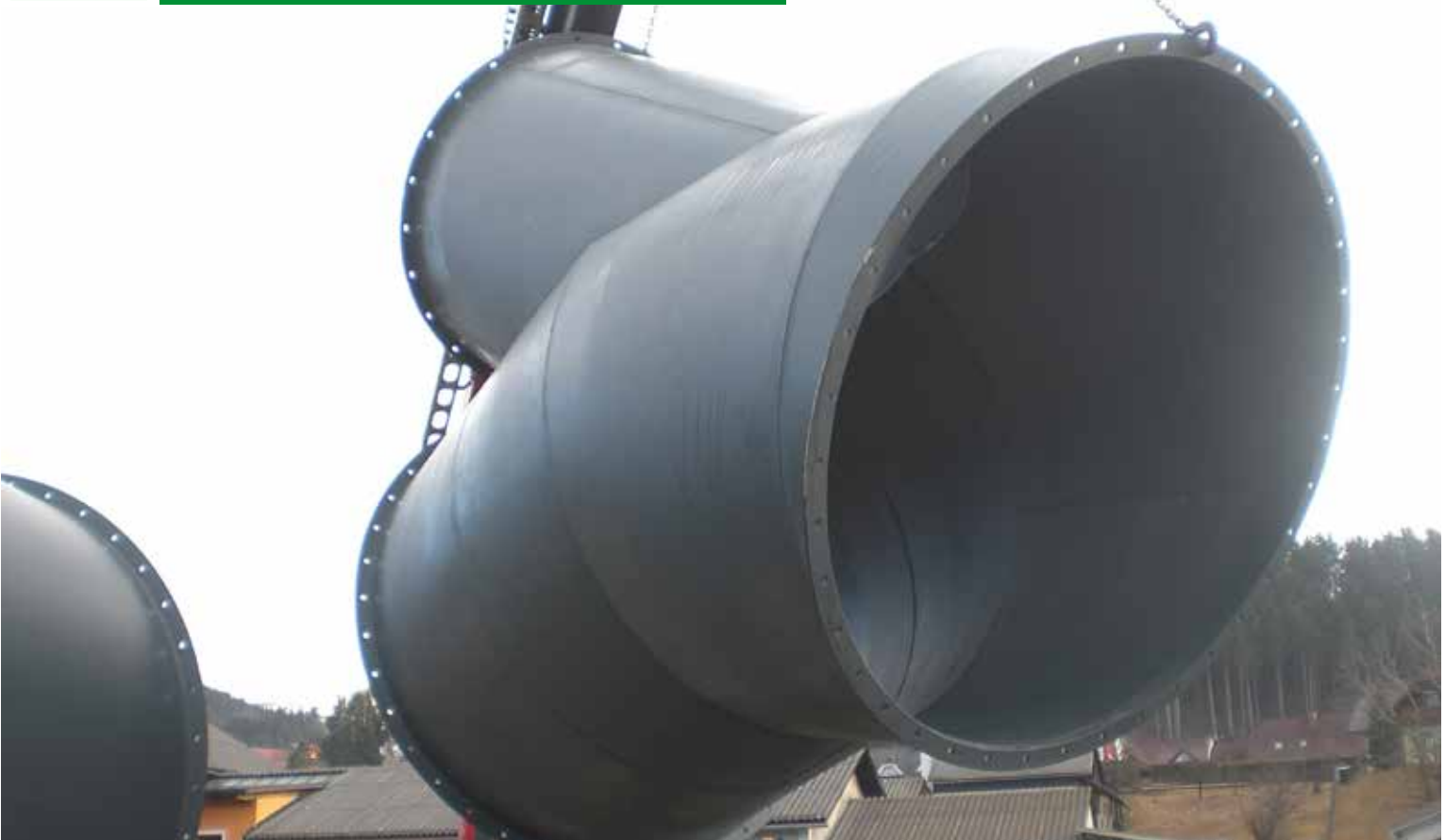
Reinluftrohrleitung Ø 2.400mm. Clean gas pipes Ø 2.400mm.
