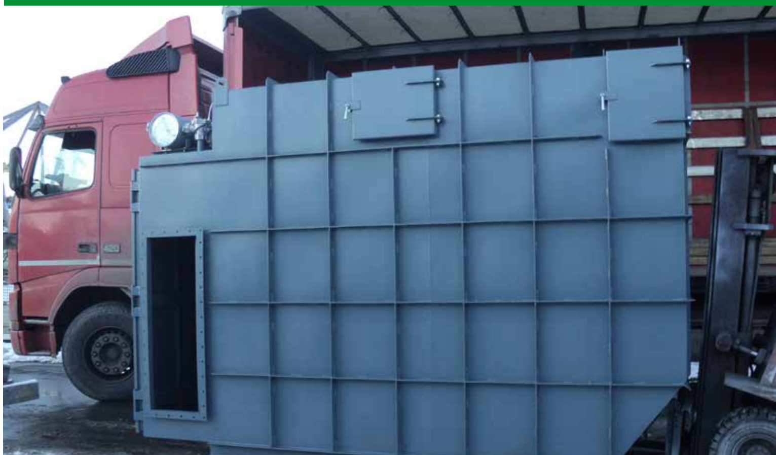
MENHOFER Oval-Schlauchfilter mit Staubsammelrumpf während der LKW-Verladung. MENHOFER oval-bag dust collector with dust collecting hopper during the LKW-loading.
