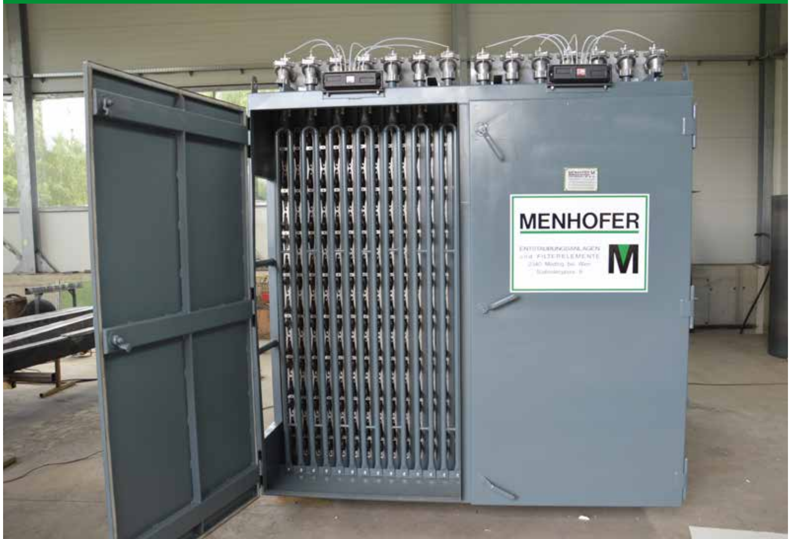
MENHOFER Oval-Schlauchfilter kurz vor der Auslieferung. MENHOFER oval-bag dust collectors shortly before delivery.
