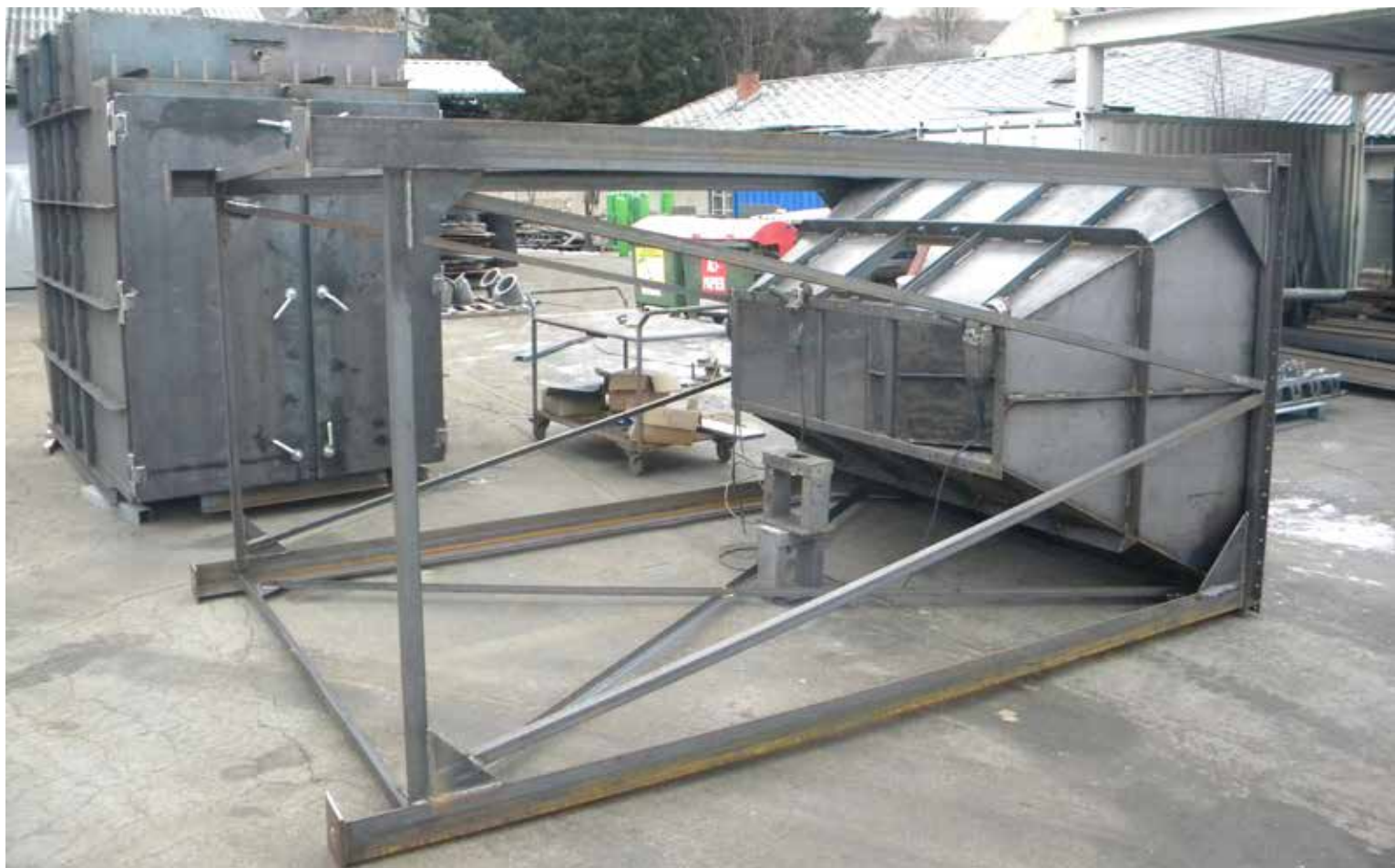
MENHOFER Oval-Schlauchfilter mit Zubehör kurz vor der Auslieferung. MENHOFER oval-bag dust collectors with accessories shortly before delivery.
