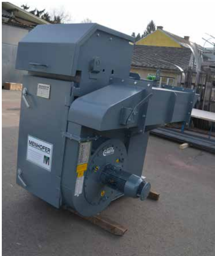
MENHOFER Oval-Schlauchfilter mit Schalldämpfer und Reinluftrohrleitung. Ausführung als Siloaufsatzfilter.
