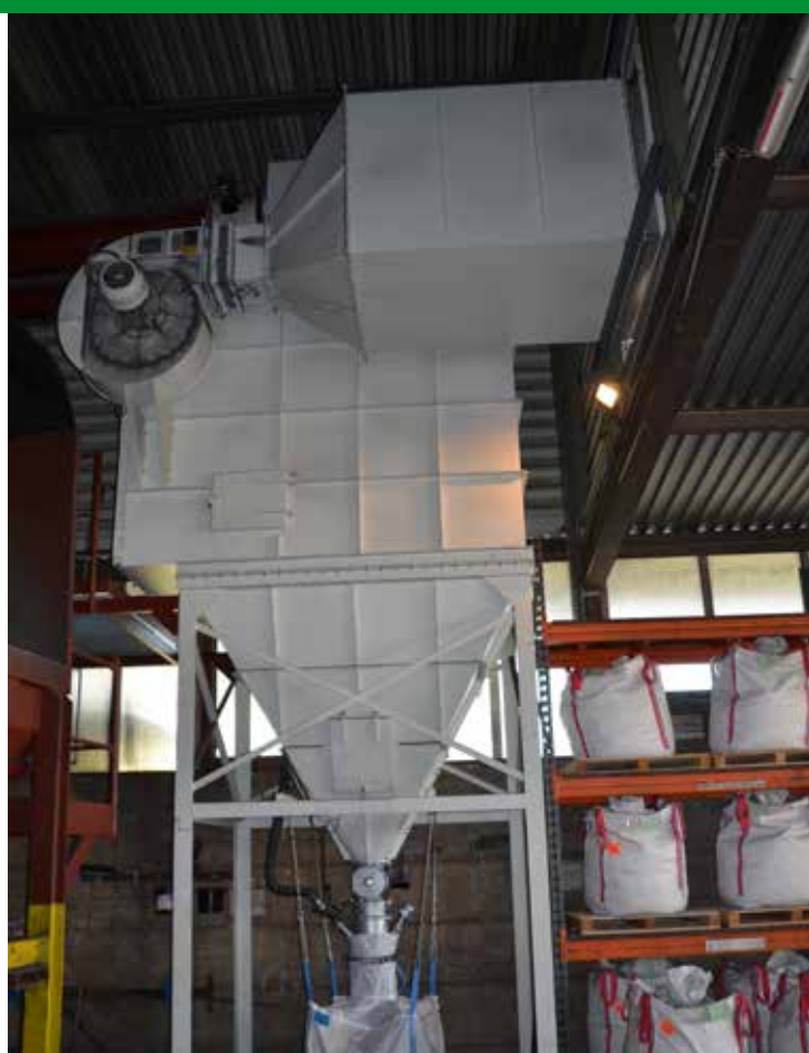
MENHOFFER Oval-Schlauchfilter mit seitlich montierter Vorabscheidekammer. MENHOFFER oval-bag dust collector with side-mounted pre-separator.
