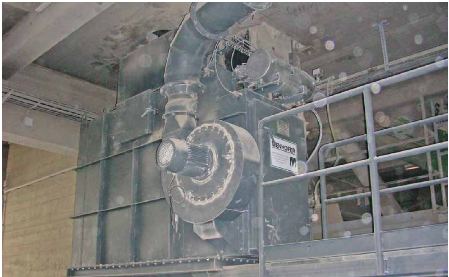
MENHOFER Oval-Schlauchfilter mit Staubsammelrumpf. Entstaubung für ein Becherwerk.
