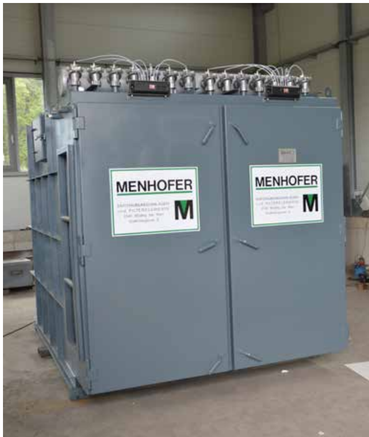
MENHOFER Oval-Schlauchfilter kurz vor der Auslieferung. MENHOFER oval-bag dust collectors shortly before delivery.
