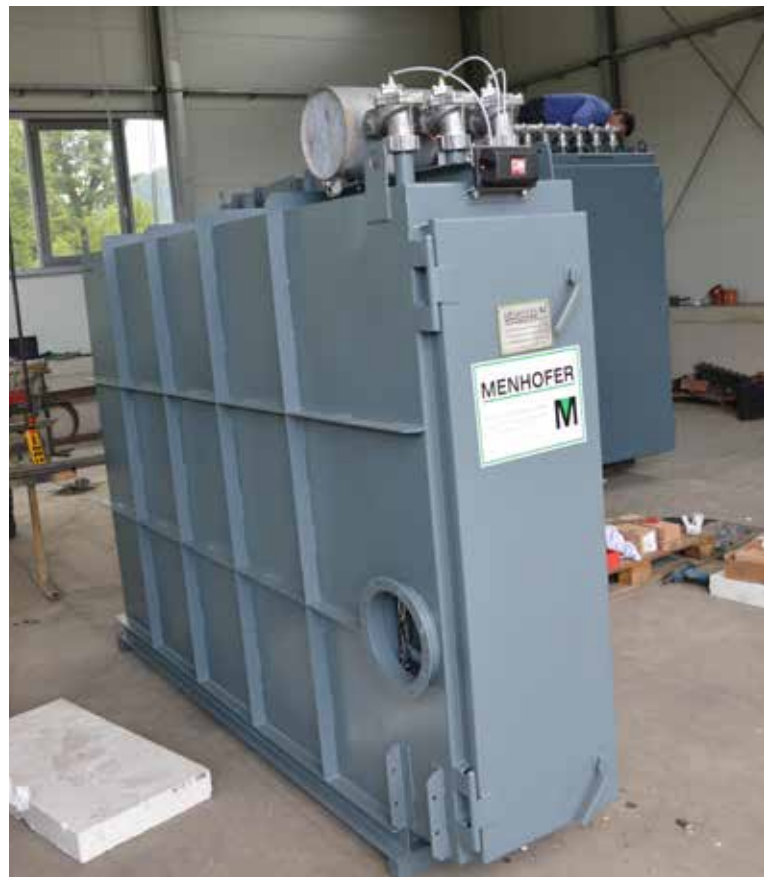
MENHOFER Oval-Schlauchfilter kurz vor der Auslieferung. MENHOFER oval-bag dust collectors shortly before delivery.
