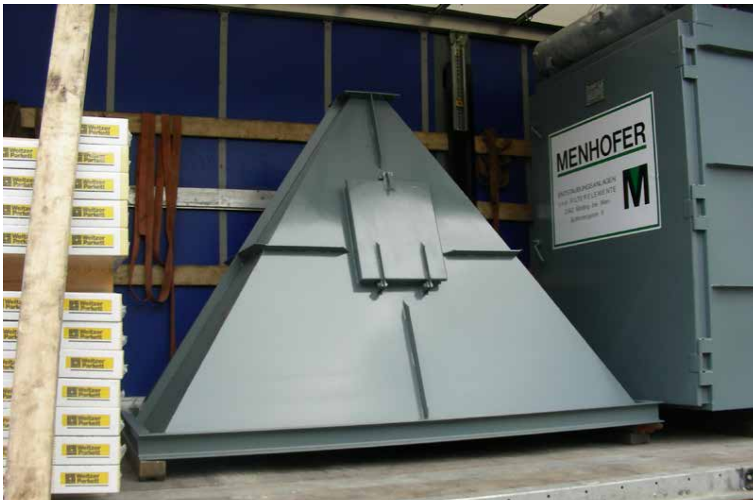
MENHOFER Oval-Schlauchfilter mit Staubsammelrumpf während der LKW-Verladung. MENHOFER oval-bag dust collector with dust collecting hopper during the LKW-loading.
