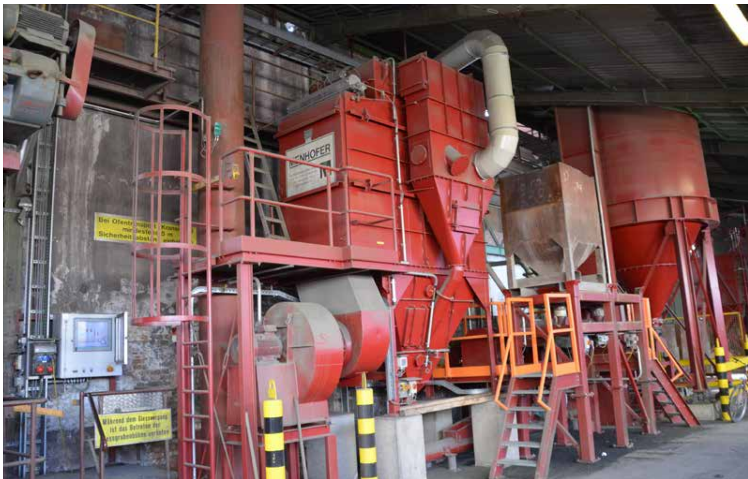
MENHOFFER Oval-Schlauchfilter mit seitlich montierter Vorabscheidekammer. MENHOFFER oval-bag dust collector with side-mounted pre-separator.
